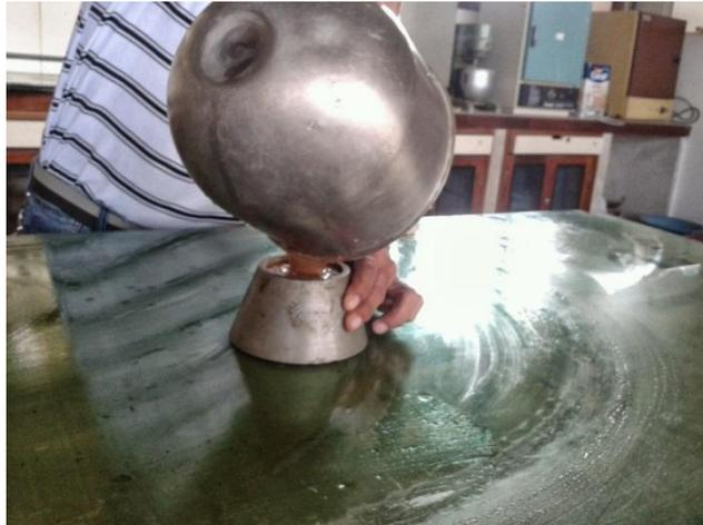
Figura 3.9 – Ensaio de consistência
