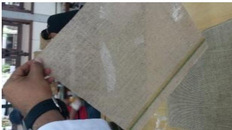
Figura 3.14 - Tecido cortado (400x400) mm e impermeabilizado.
