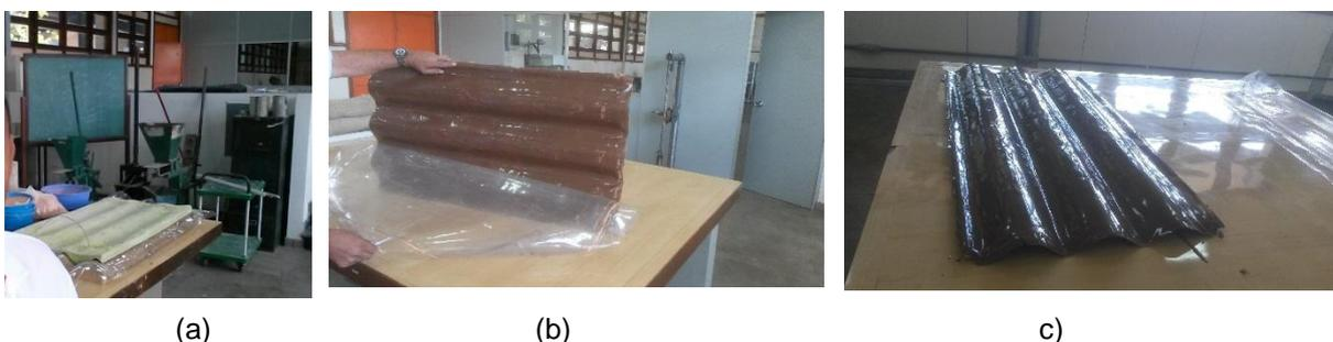
Figura 3.22 – Desforma das telhas: (a) Descanso da telha com a forma de concreto na parte superior, (b) face da telha desformada sem aderência da toalha de plástico, (c) Telha desformada.
