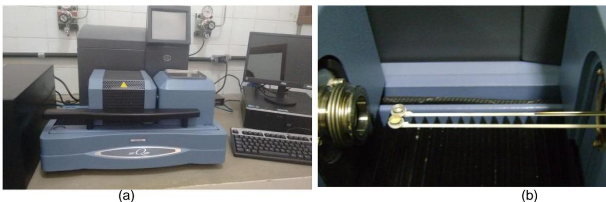
Figura 3.24 – Análise térmica: (a) Equipamento usado na análise termogravimétrica; (b) Amostra em cadinhos de platina.
