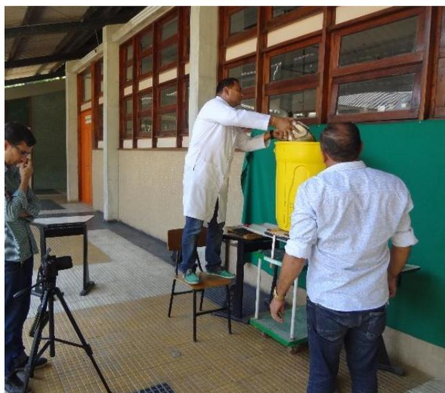
Figura 3.29 – Detalhe do ensaio de flexão: Câmera digital acoplada ao ensaio para aquisição de imagens.
