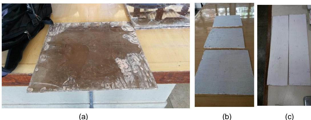
Figura 3.18 – Preparação das placas para ensaios mecânicos: (a) placa desformada, (b) placa pintada de branco, (c) Amostras para o ensaio de flexão.
