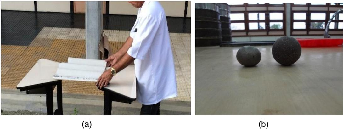
Figura 3.31 – Ensaio de resistência ao impacto: posicionamento do corpo-de-prova apoiado em 2 mesas, (b) Esferas utilizadas no ensaio de resistência ao impacto.
