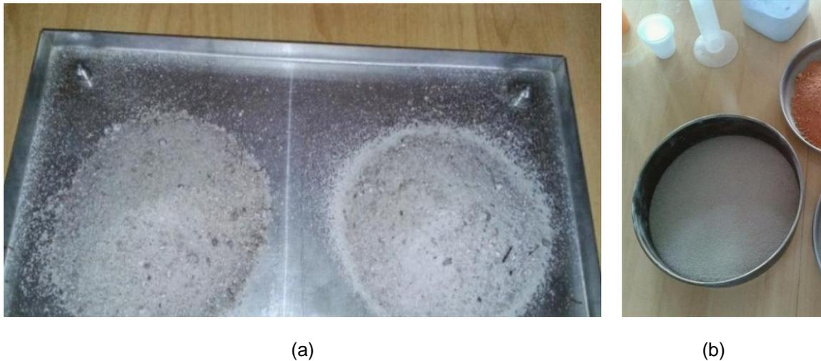
Figura 4.2 – Amostra da areia: (a) areia no estado que foi fornecida pela empresa de concreto, (b) areia peneirada com diâmetro menor de 1,18mm.
