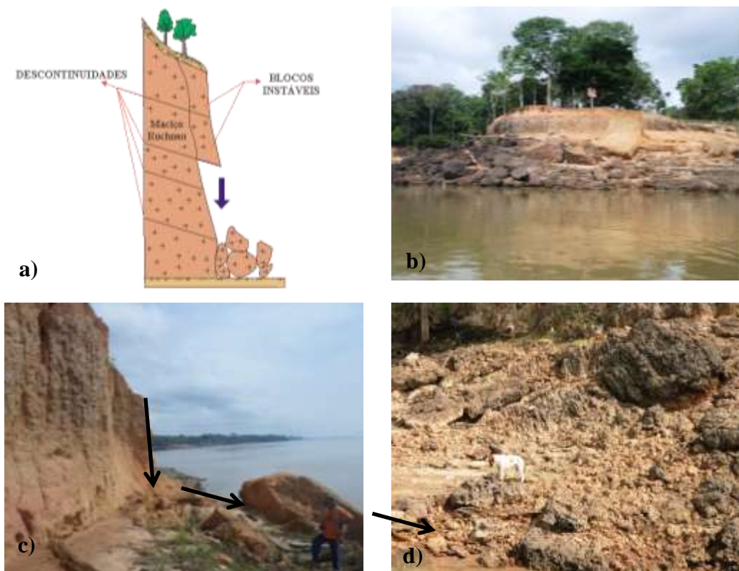
Figura 2. 6: Movimento gravitacional do tipo queda de blocos. a) Esquema de queda de blocos rochosos por efeito da gravidade. FONTE: Fábio Reis (UNESP, 2015), modificada de Infanti Jr. e Fornasari Filho (1998). b) Perfil observado durante o trabalho de campo evidenciando o movimento de massa de tipo de queda em blocos. Data: 05 de novembro de 2015. c) Perfil de latossolo amarelo recoberto por paleossolo laterítico na margem esquerda do rio Madeira apresentando encosta íngreme. d) Blocos movimentados depositados no sopé do barranco recobertos por sedimentos fluviais. Coordenadas: 03° 41' 19,9" S 59° 06' 05,10" W. Data: 05 de novembro de 2015.
