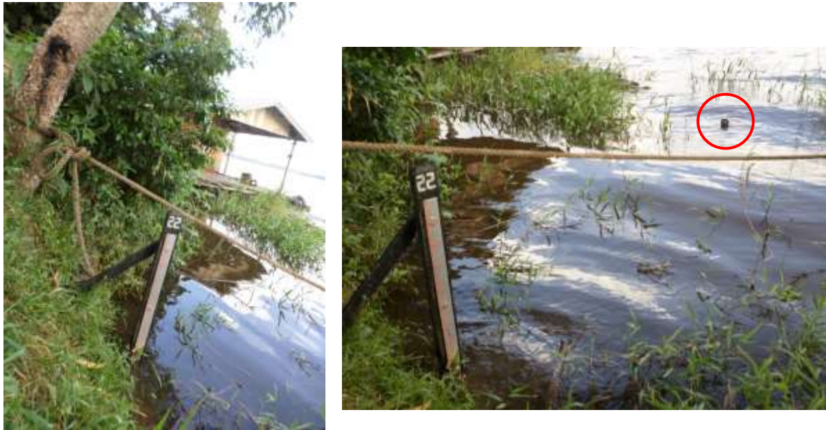
Figura 6.13: Régua fluviométrica localizada as margens do Paraná do Madeirinha. A régua fluviométrica mostra o nível das águas, em períodos de cheia e vazante fluvial e fornece os dados referentes a cotas máximas e mínimas do nível do rio. Os dados quando comparados às cotas dos anos anteriores auxiliam a previsão do nível do rio, e de possíveis cheias excepcionais ou grandes vazantes. Os dados referentes à estação não puderam ser tabuladas, pois não foram encontradas junto ao órgão responsável pela medição. O círculo vermelho destaca a saliência da outra estaca utilizada para marcação do nível da água, quase totalmente submersa, durante a cheia fluvial. Coordenadas: 03° 34' 28,5" S 59° 07' 50,6" W. Data: 18 de junho de 2015.
