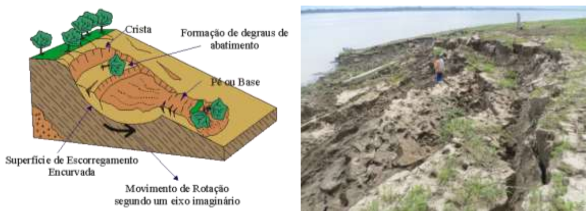
Figura 2. 5: Escorregamento rotacional. a) Esquema de escorregamentos rotacional, com forma arredondada do local movimentado e o degrau de abatimento formado acima da massa deslizada. FONTE: Fábio Reis (UNESP, 2015), modificada de Infanti Jr. e Fornasari Filho, 1998. b) Feição de deslocamento de massa na margem esquerda do rio Madeira apresentando formato de cunha onde o movimento gera patamares no sentido jusante em direção ao nível da água, indicando prenúncio de escorregamento, com o aparecimento de fendas e rachaduras no entorno do terreno. As características do movimento gravitacional de massa do tipo de escorregamento rotacional são similares aos encontrados na área de estudo, constatada durante o trabalho de campo, na vazante do rio. Sendo essas feições, a constituição de cristas, a formação de degraus de abatimento, e uma superfície de escorregamento encurvada. A diferença mais notada entre as características da área de estudo e o conceito de movimentos gravitacionais de massa se refere à ao nível de base e à ausência de encostas íngremes, pois esse tipo de movimento foi visualizado em terrenos topograficamente mais planos, onde o nível de base é representado pelo nível da água, o rio Madeira. Coordenadas: 03° 42' 18,8" S 59° 06' 06,4" W. Data: 05 de novembro 2015.
