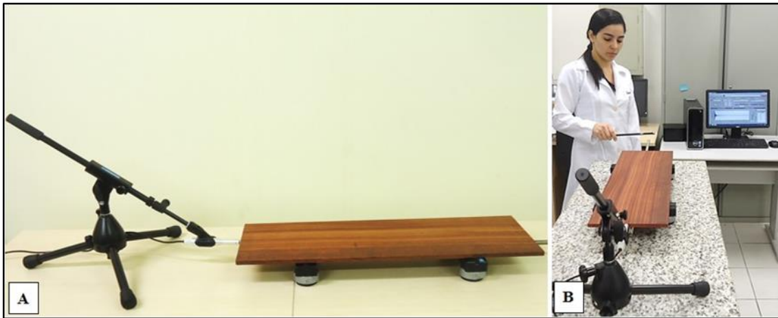
Figura 11 - Ensaio pela a técnica de excitação por impulso. (A) condição de contorno referente à vibração do modo longitudinal; (B) amostra submetida ao ensaio. Fonte:
