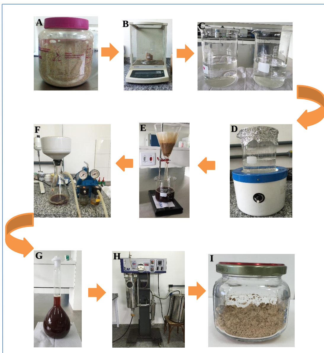
Figura 3- A) Casca do caule; B) Pesagem; C) Água/Álcool; D) Infusão; E) Filtragem grossa; F) Bomba a vácuo; G) Balão volumétrico 1000mL; H) Aparelho Spray Dryer; I) Extrato seco da L. ferrea .
