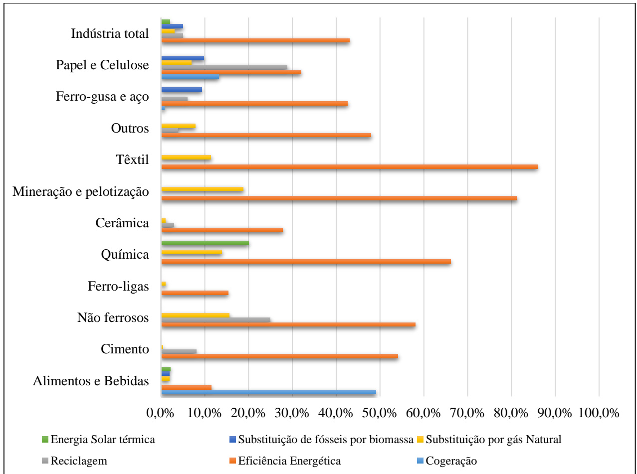
Figura 32: Percentagem por segmento industrial de contribuição das medidas para abatimento de CO 2 acumulado entre 2010 e 2030
