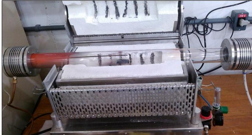
Figura 22. Forno utilizado para realizar o tratamento térmico
