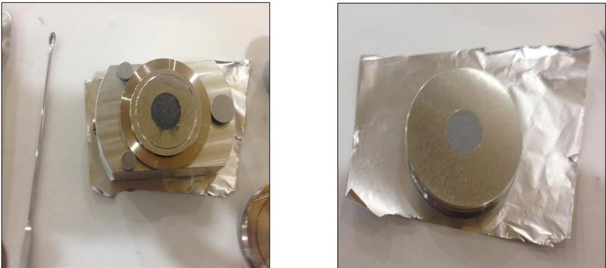
**Figura 18.** Preparação da amostra para realização de DRX
