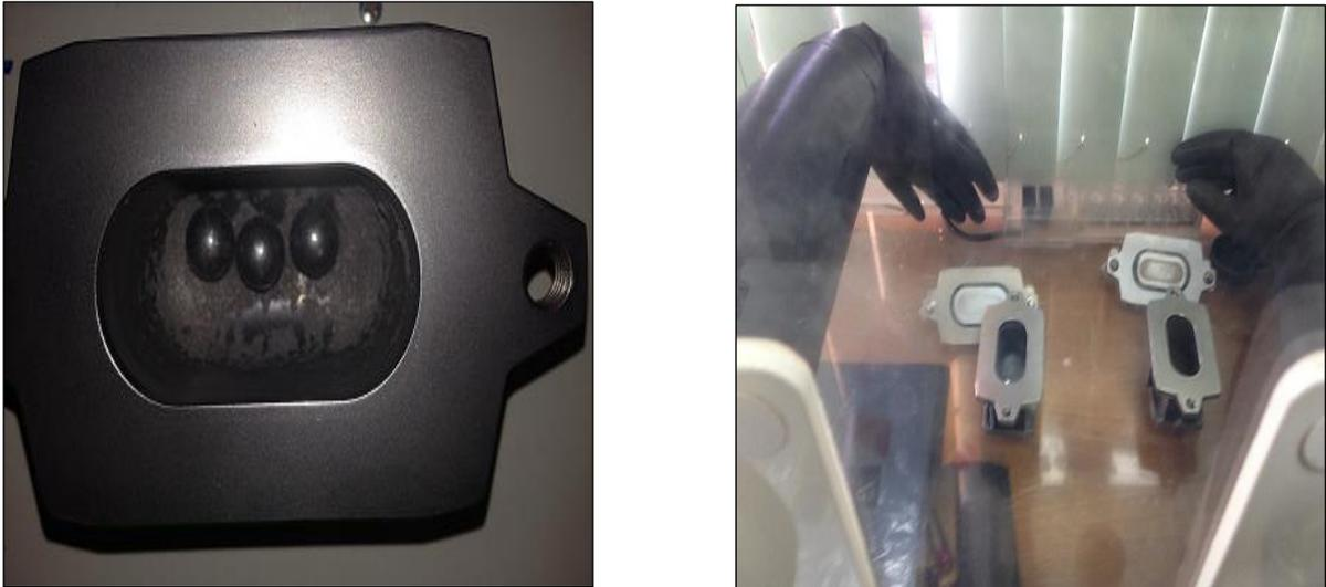
**Figura 17.** Preparação e selagem do vaso de moagem
