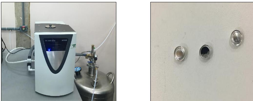
Figura 23. Equipamento utilizado para realizar o DSC
