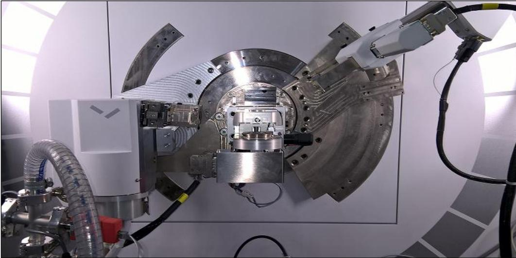
**Figura 19.** Difratorômetro de Raio-X modelo Empyrean da PANalytical
