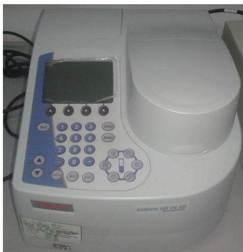
**Figura 20.** Espectrofotômetro UV-vis da marca Thermo Scientific™, modelo GENESYS 10S.
