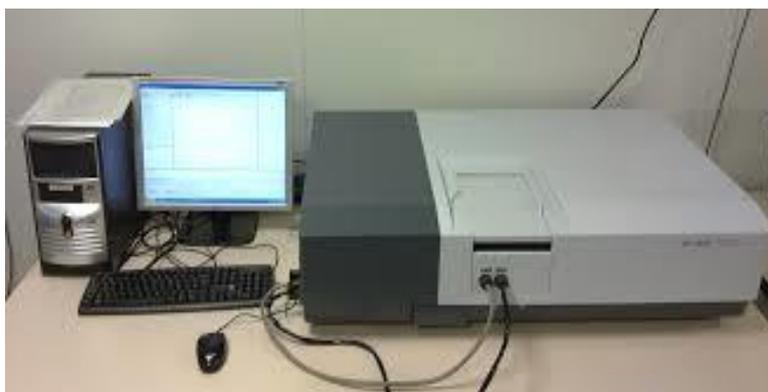
**Figura 17.** Espectrofotômetro UV-vis da marca SHIMADZU, modelo UV-3600.
