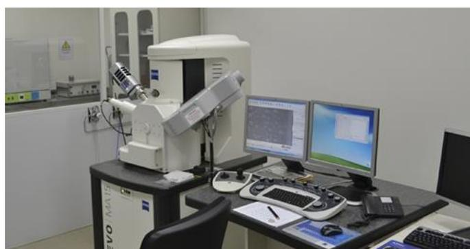
**Figura 16.** Microscópio eletrônico de varredura da marca Carl Zeiss, modelo LEO435VP.
