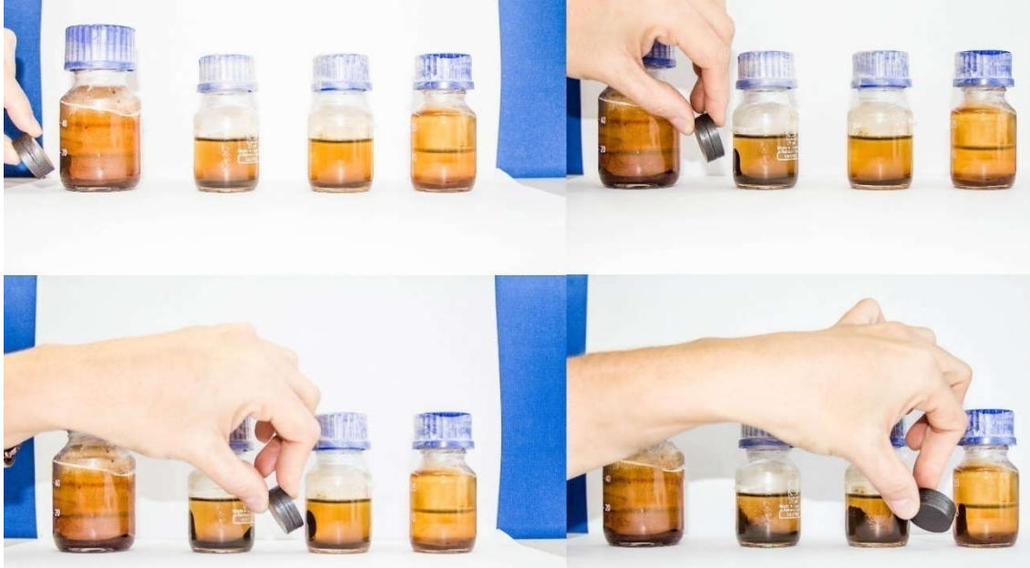
Figura 44. Fotografias demonstrando, em nível macroscópico, a magnetização das Amostras.
