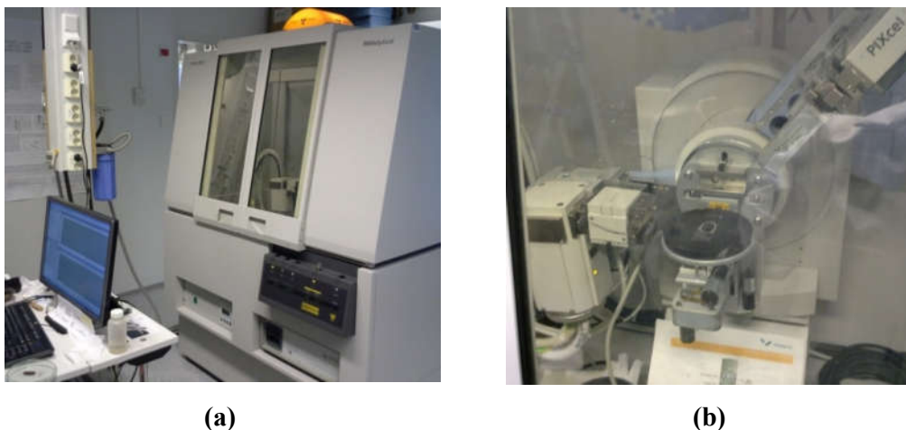
Figura 20. (a): Aparelho de Difração de Raio-X, modelo X’Pert PRO da marca PANalytical. (b): Lâmina de vidro, contendo amostra do material, inserida no aparelho no momento do ensaio.
