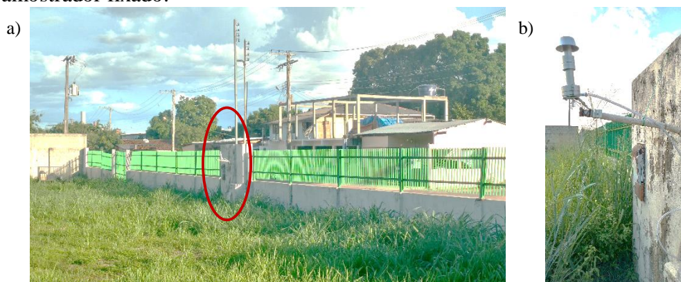
Figura 9: Ponto de coleta do ar exterior na EEIV. a) Local de instalação do amostrador, b) amostrador fixado.
