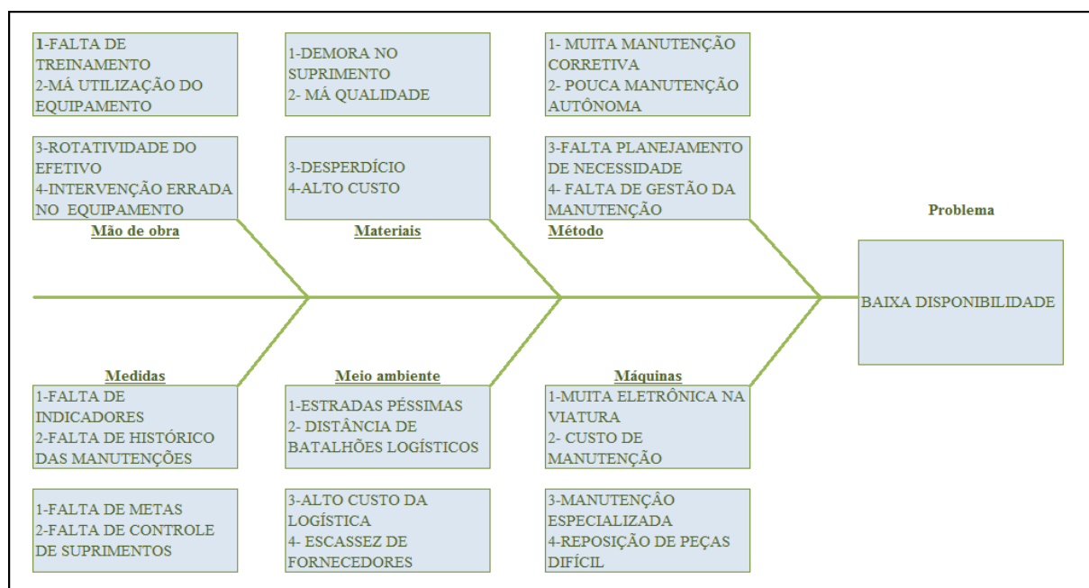
Figura 11 -Diagrama de causa e efeito (6M) dos problemas que atuam na diminuição de disponibilidade da frota do 54° BIS
