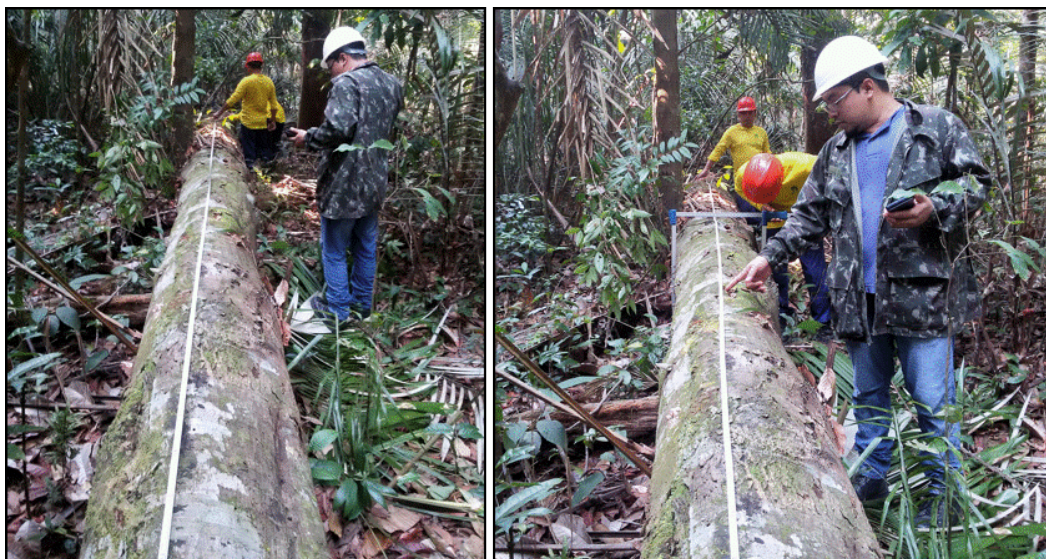
Figura 5: Cubagem rigorosa de troncos caídos para estimativa do volume de necromassa através do método combinado de Smalian-Hohenald .
