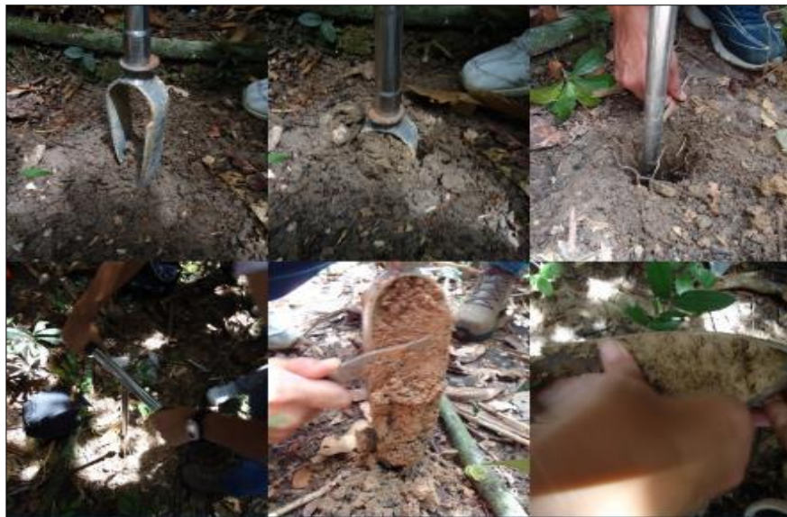
Figura 37: Coleta de solos através de tradagem. Fonte: Daniela Carvalho (2013).
