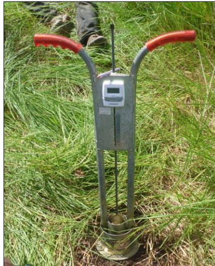
Figura 41: Infiltrômetro. Fonte: Daniela Carvalho (2013).
