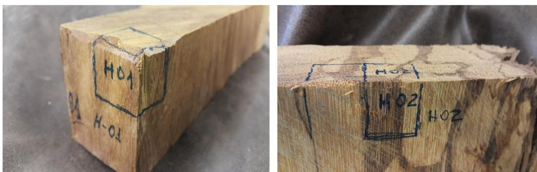
Figura 26 – Marcação para retirada dos corpos de prova para identificação da madeira
