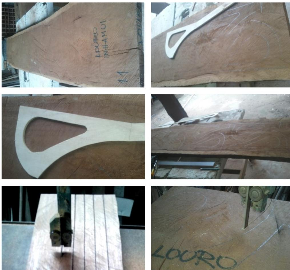
Figura 30 - Corte das peças para confecção das pernas das mesas (protótipos)
