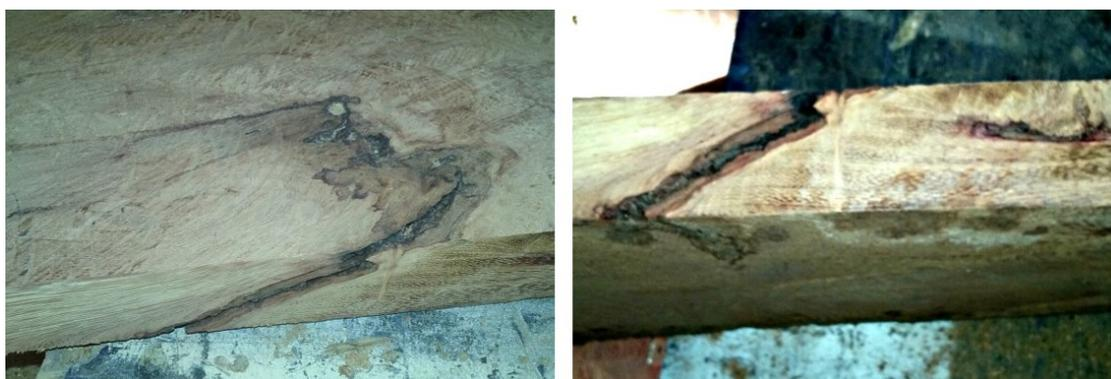
Figura 48 – Resíduos de madeira com avarias causadas por fungos e exposição a intempéries
