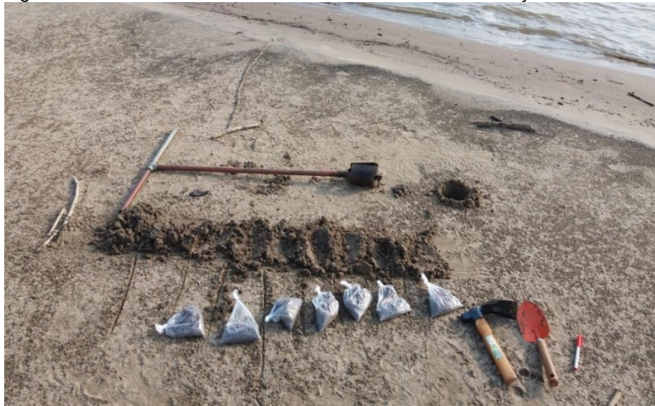
Figura 29: Coleta de amostras de solo da barra de sedimentação.
