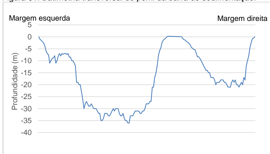
Figura 61: Batimetria transversal do perfil da barra de sedimentação.
