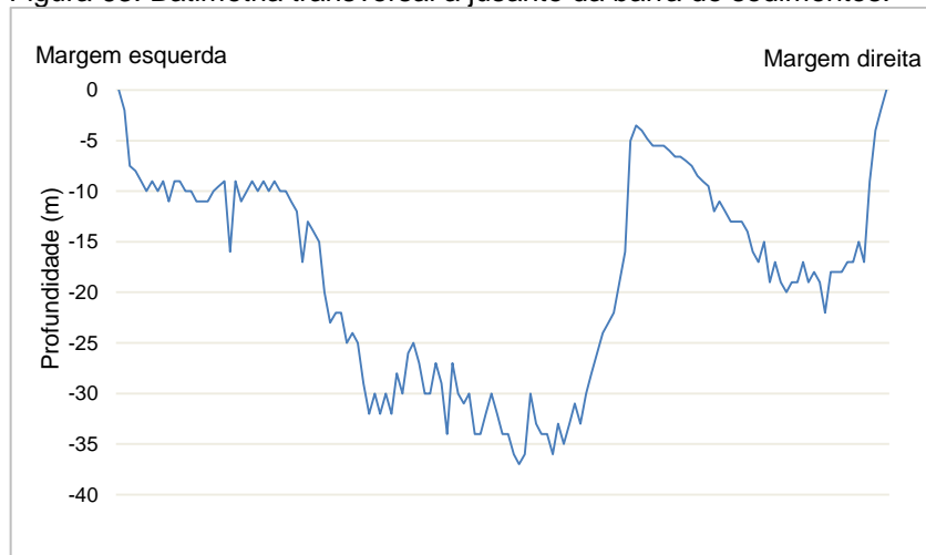
Figura 63: Batimetria transversal a jusante da barra de sedimentos.
