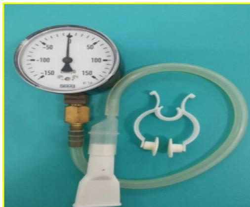
Figura 5- Manovacômetro da marca WIKA, modelo cl 1.6, analógico.
