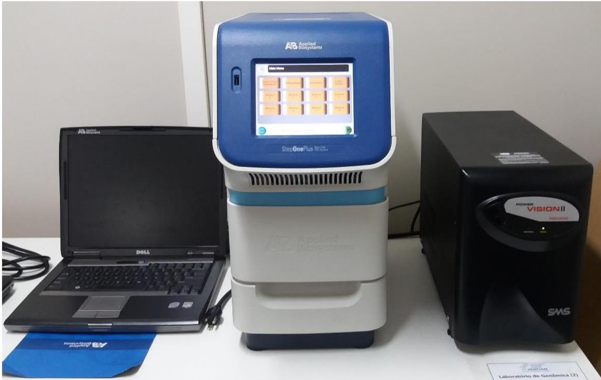
Figura 6. Equipamento automatizado *StepOne Plus Real System* (Life Technologies, Foster City, CA) utilizado na técnica de PCR em Tempo Real.
