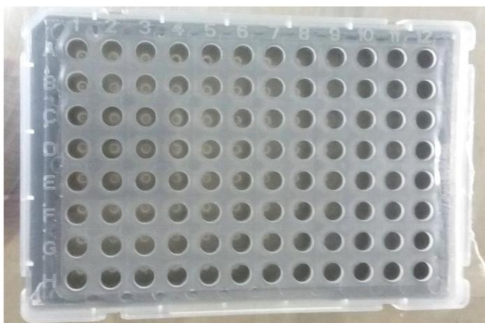
Figura 8. Microplaca com 96 poços utilizada para a realização da técnica de PCR em Tempo Real.
