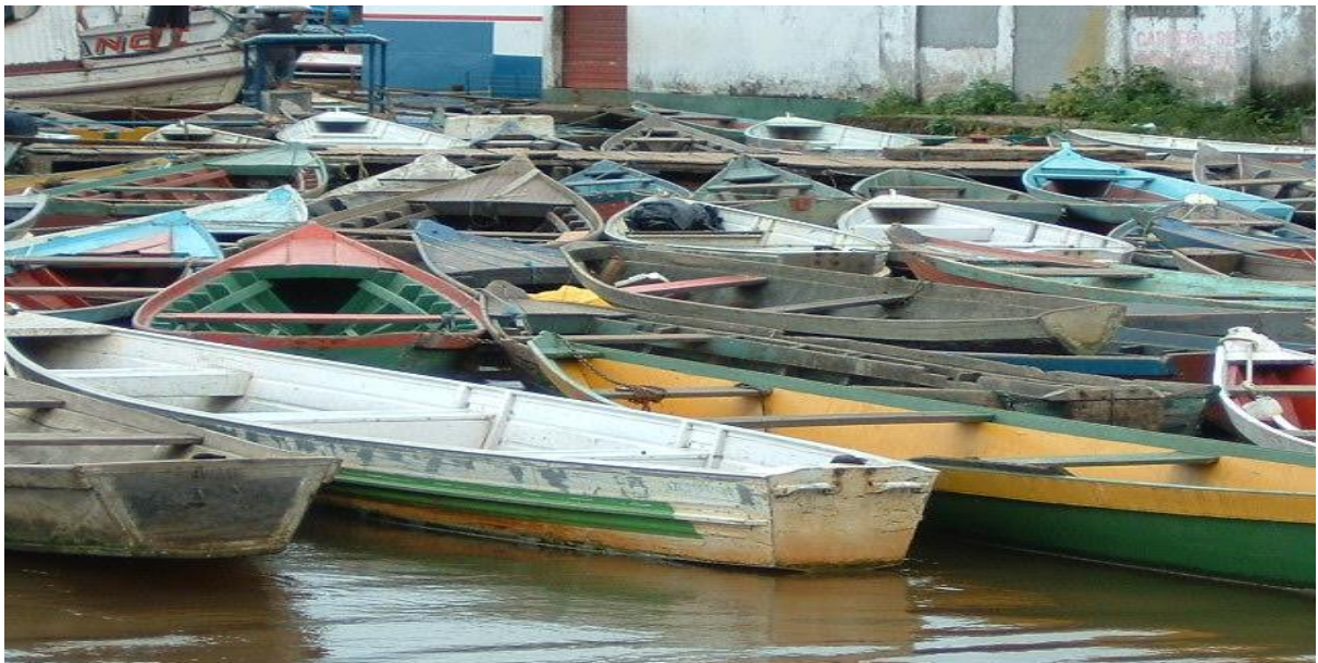
Figura 8c - Variedade de forma geométrica da popa das embarcações
