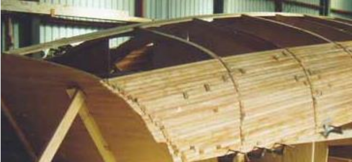
Figura 48 - Embarcação produzida pelo processo Strip Plank
