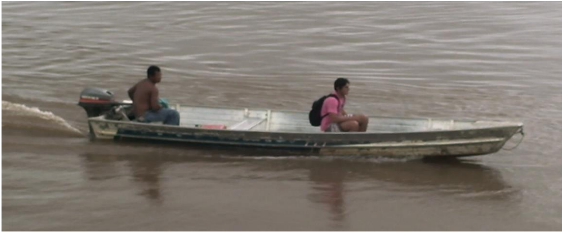
Figura 3 - Voadeira construída em alumínio com motor de popa
