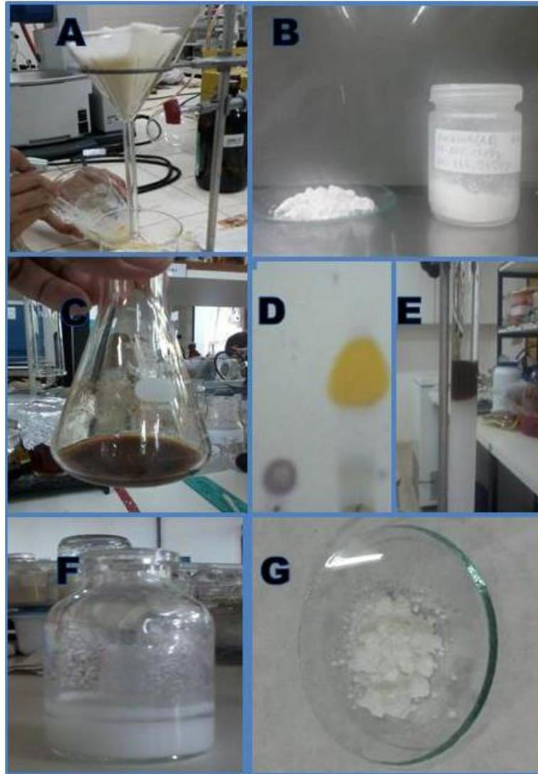
Figura 5B – Processo de purificação e síntese. A – lavagem de frações F3, F4 e F5; B – mistura de  $\alpha$ ,  $\beta$ -amirina; C – processo de síntese; D – filtração do eluato; E – Fração com amirenona; F e G –  $\alpha$ , $\beta$ -amirenona.
