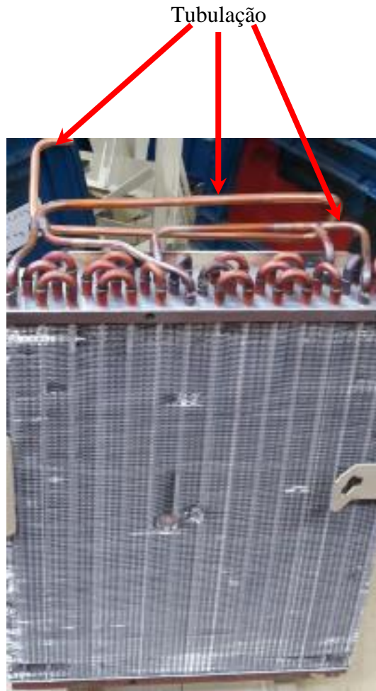
Figura 26 – Exemplo de trocadores e suas peças para soldadar
