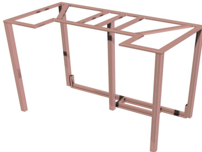
Figura 17: Estrutura de apoio do tampo
