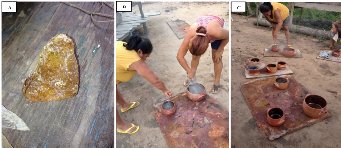
Figura 97. Vitriificação das vasilhas de barro. A) Jutaicica. B) Ceramistas do Mocambo passando a jutaicica nas vasilhas. C) Vasilhas de barro vitrificada.
