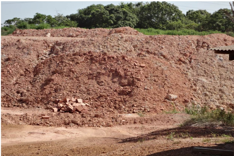
Figura 8 – Pátio de armazenamento de material argiloso para cerâmica vermelha. Cerâmica Santa Catarina. Com descarte de tijolos pós extrusão – não queimados (2015).
