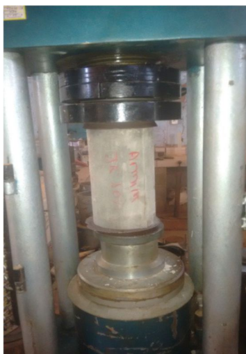
Figura 14 – Posicionamento dos corpos de prova na máquina de ensaios para aplicação da carga e determinação da resistência à compressão.
