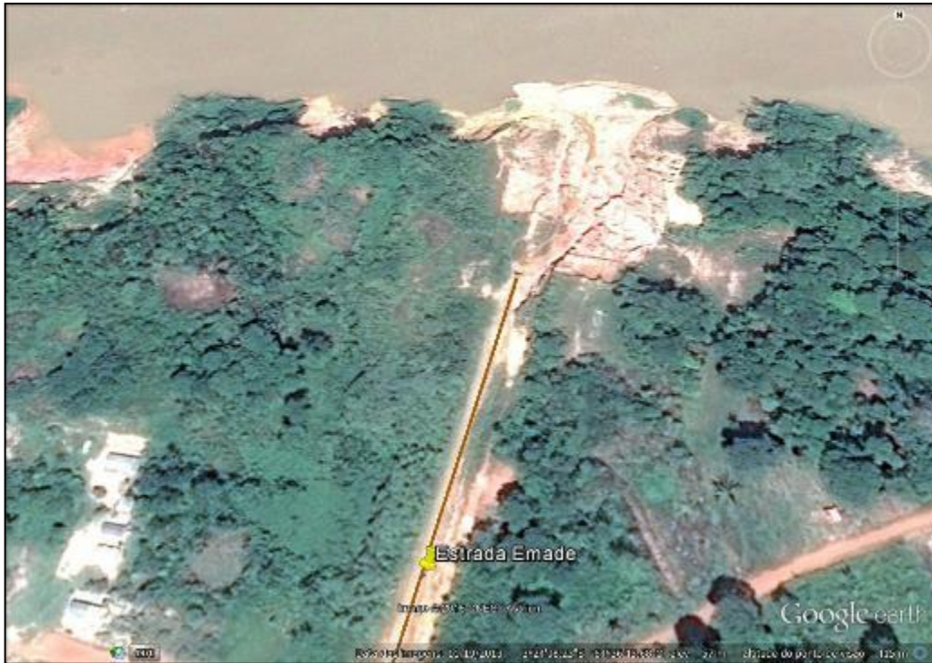
Figura 8: Voçorocamento no trecho final da estrada Emade anteriormente citado, processo erosivo localizado próximo do rio Solimões, nas laterais a presença da vegetação secundária, processo visto a partir de imagem de satélite
