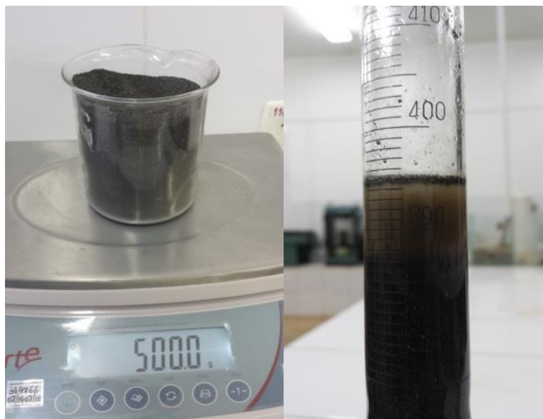
Figura 10 - Análise massa específica pelo frasco Chapman
