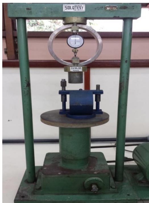
Figura 21 - Ensaio Marshall (Laboratório de Pavimentação da UFAM)
