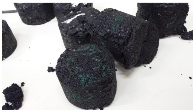
Figura 20 - Corpo de prova rompido no ensaio Marshall (Laboratório de Pavimentação da UFAM)
