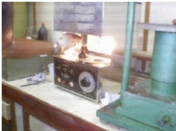
Figura 19 - Ensaio de viscosidade Saybolt-Furol ( Laboratório de pavimentação da UFAM)
