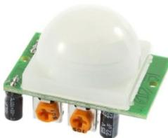
**Figura 26 - Sensor eletrônico de presença.**
