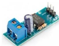
**Figura 22 - Sensor eletrônico de tensão.**
