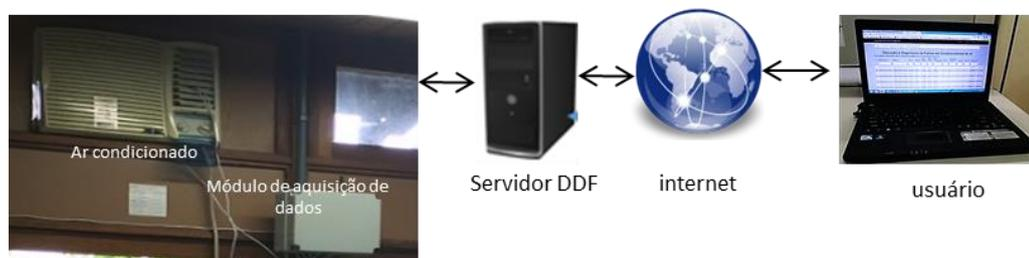
**Figura 44 – Módulo de aquisição, servidor DDF, internet e usuário.**
