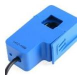
**Figura 23 - Sensor eletrônico de corrente.**
