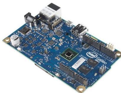
**Figura 30 - Placa de aquisição de dados Intel Galileo.**
