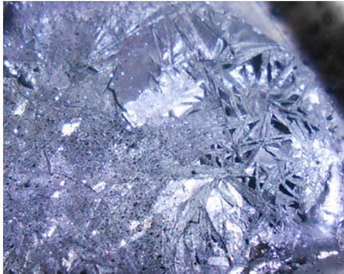
Figura 19. Amostra de SnSe fundida, observa-se os grandes cristais formados após o resfriamento.
