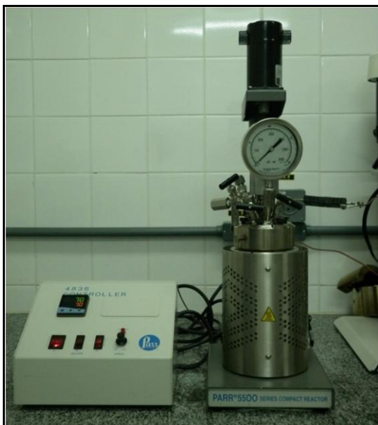
Figura 15: Reator Parr utilizado nas reações de transesterificação.
