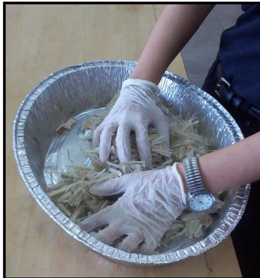
Figura 17: Processo manual de impregnação fibras/resina.
