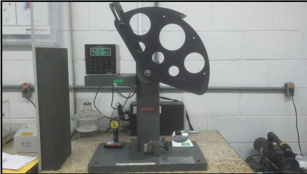
Figura 20: Equipamento de teste de impacto Tinius Olsen 92T.
