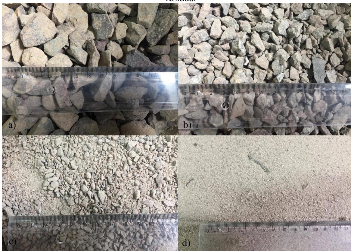
Figura 15–Materiais utilizados na pesquisa: a) brita 1; b) brita 0; c) pó de pedra; e d) areia residual
