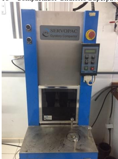
Figura 18 – Compactador Giratório Superpave (CGS)
