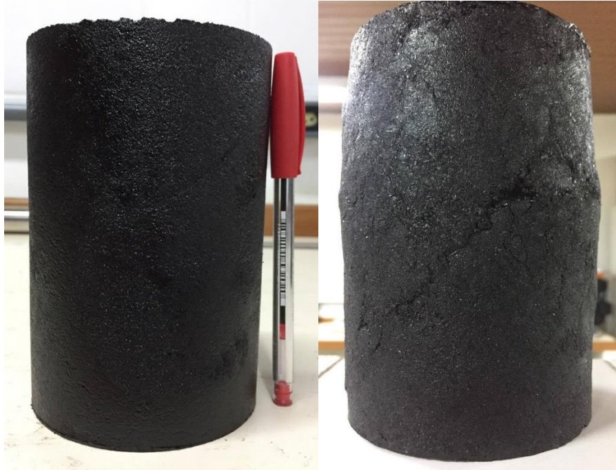
Figura 31 – Corpo de prova antes e após a realização do ensaio triaxial
