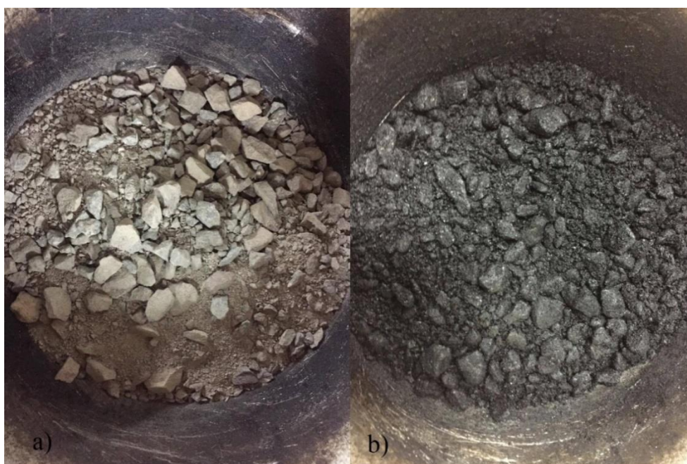
Figura 17 – Realização da mistura asfáltica: a) antes de adicionar o ligante; e b) após adição do CAP e homogeneização da mistura
