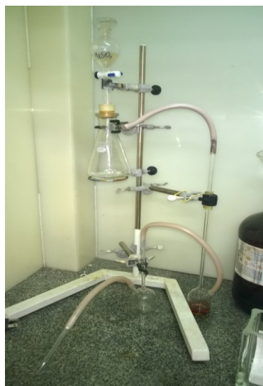
Figura 30. Sistema de borbulhamento para obtenção de HCl gasoso
