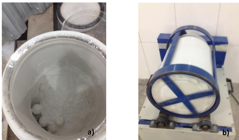
Figura 11 - (a) disposição do resíduo de vidro no jarro e (b) operação de moagem
