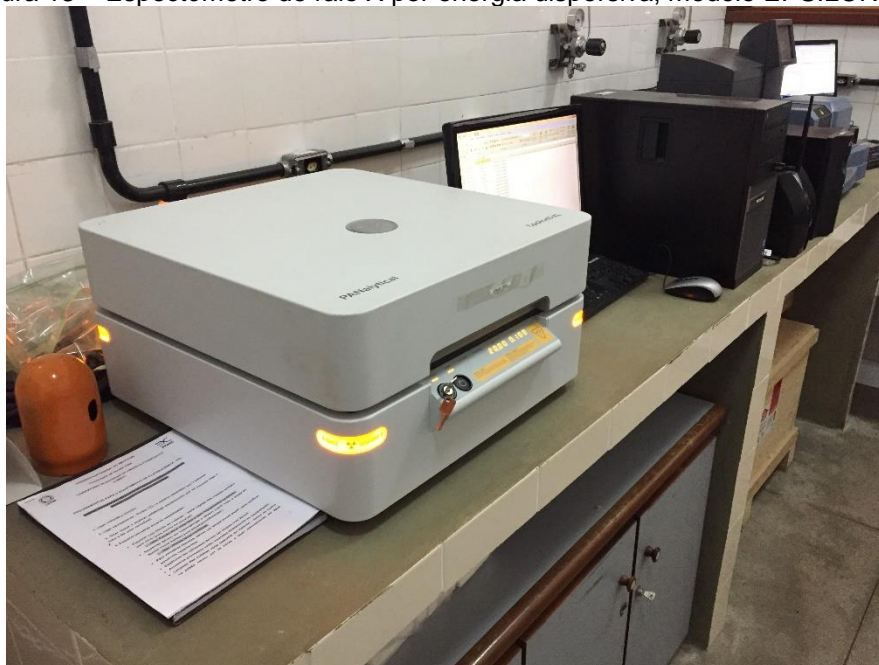
Figura 13 – Espectrômetro de raio X por energia dispersiva, modelo EPSILON 3XL
