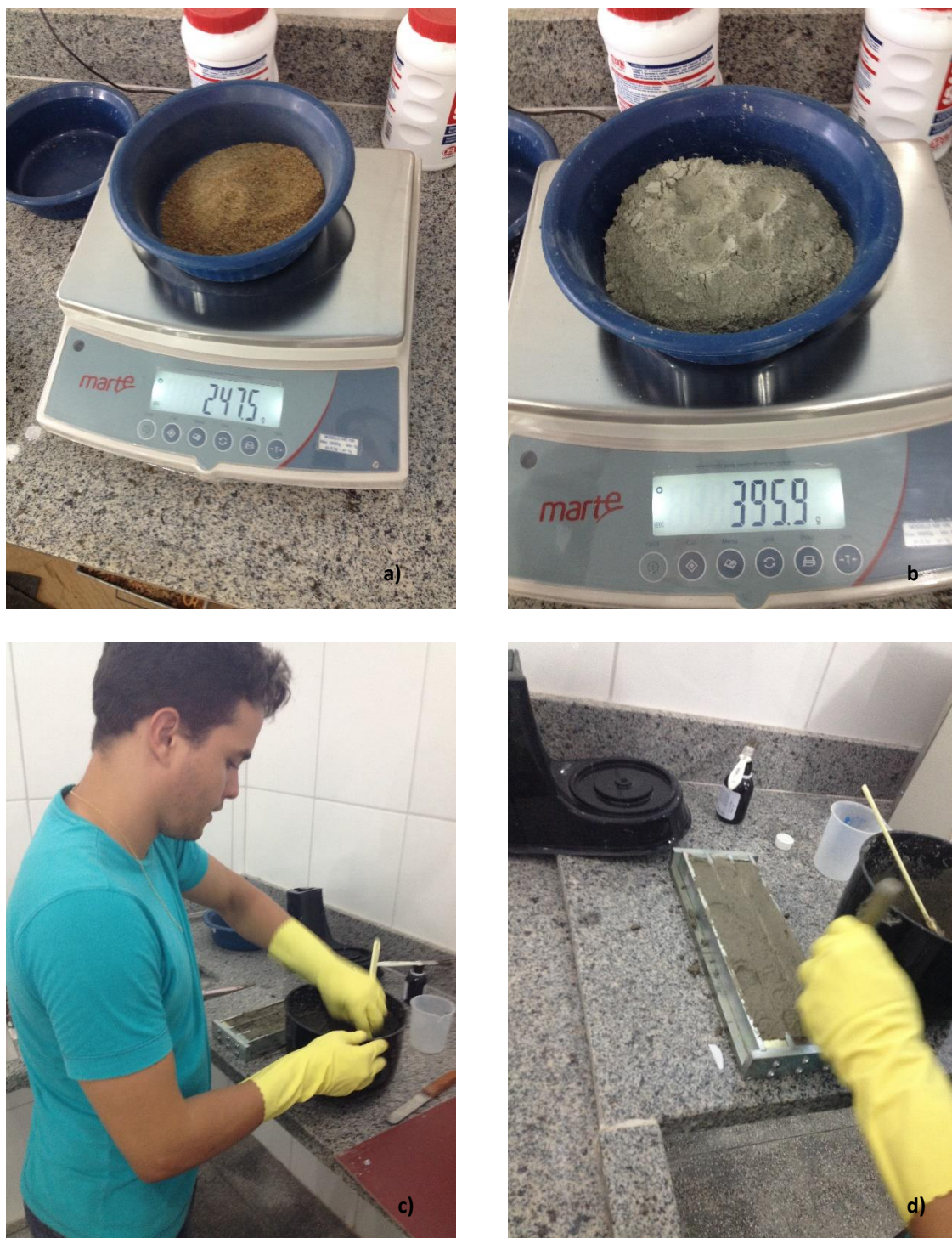
Figura 16 – Separação dos materiais para ensaio de RAA (a) e (b), confecção dos traços (c) e (d).
