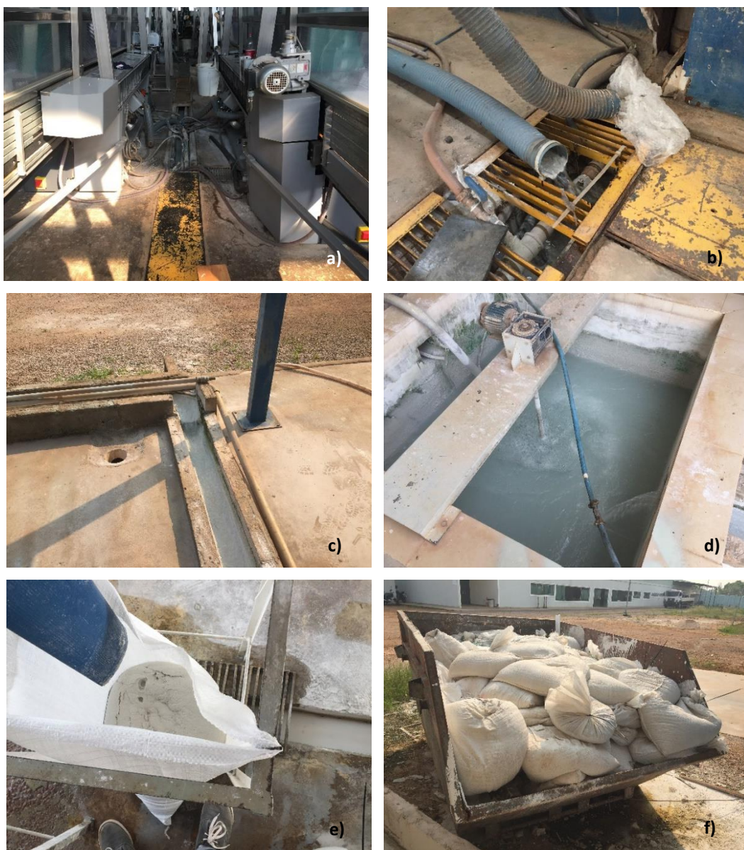
Figura 8 – Calha de recolhimento das máquinas de desbastamento (a), (b) e (c), processo de adição de floculante a água com resíduo de vidro (d), acondicionamento de resíduo de vidro em sacos plásticos de 60 kg (e) e depósito de resíduo em caçamba estacionária (f).
