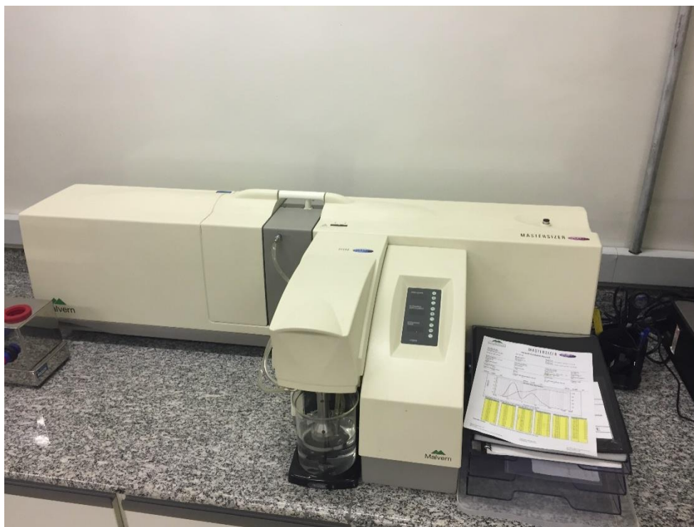
Figura 12 – Analisador de partículas à laser LAMIN, CPRM Manaus.
