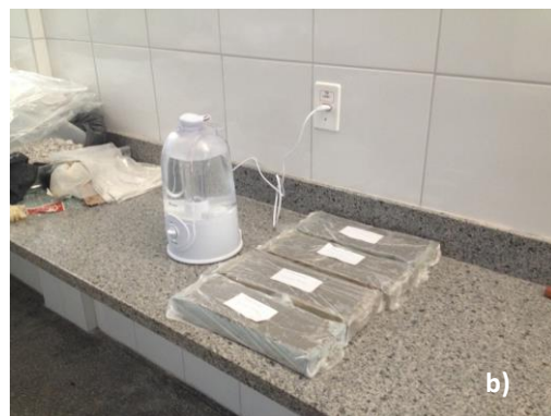
Figura 17 – (a) confecção de barras de argamassa, (b) barras em ambiente úmido, (c) barras em solução de hidróxido de sódio dentro da estufa ventilada e (d) equipamento de medição de expansão
