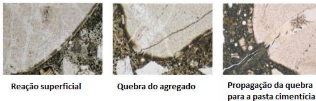
Figura 5 - Reação Álcali-agregado, fissuração do agregado e propagação da fissura para pasta cimentícia
