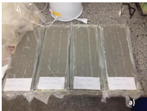
Figura 17 – (a) confecção de barras de argamassa, (b) barras em ambiente úmido, (c) barras em solução de hidróxido de sódio dentro da estufa ventilada e (d) equipamento de medição de expansão
