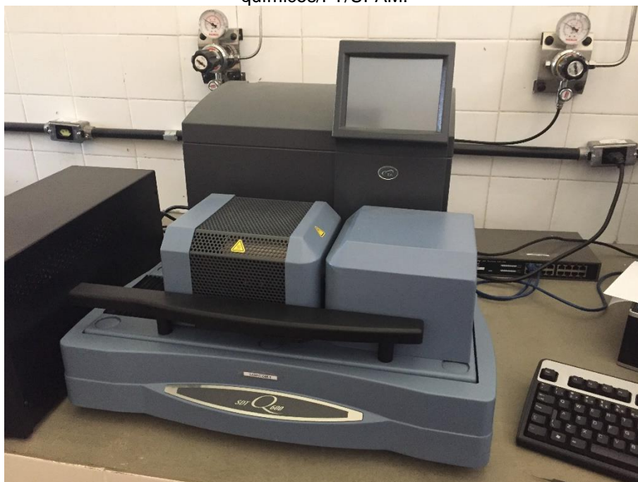
Figura 18 - Equipamento termogravimétrico do laboratório de ensaios físico-químicos/FT/UFAM.
