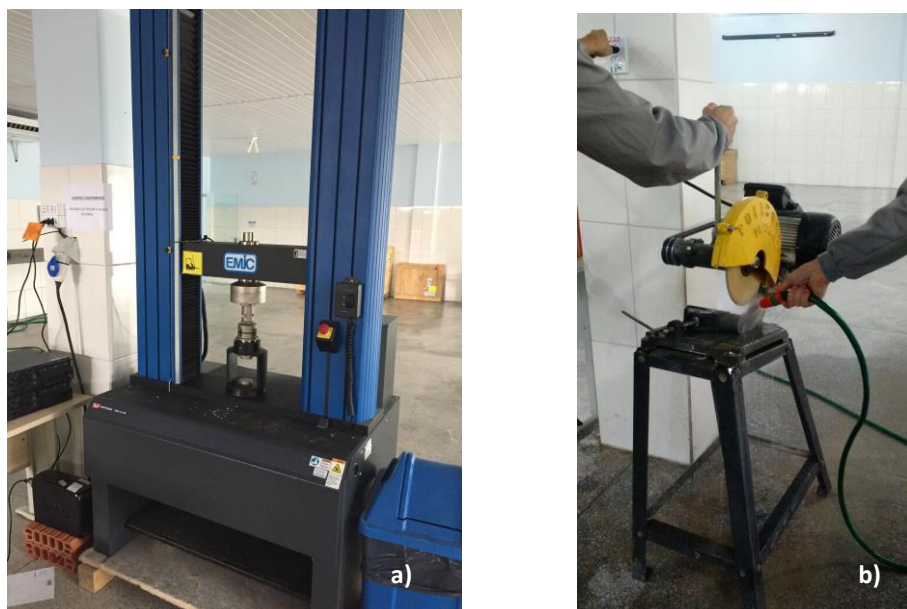
Figura 21 - (a) Máquina Universal de ensaios mecânicos e (b) máquina policorte para retificação das superfícies dos corpos de prova
