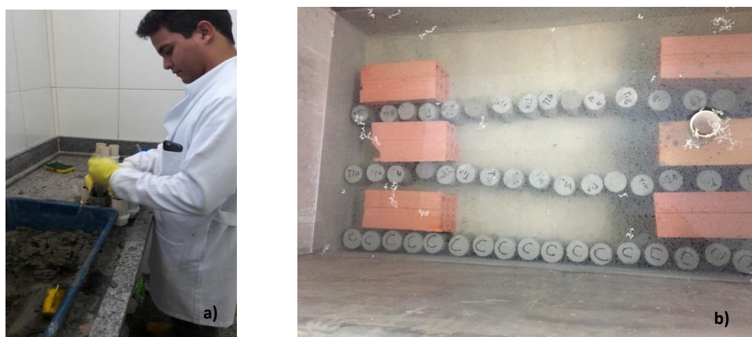
Figura 20 - (a) Moldagem dos corpos de prova e (b) cura submersa
