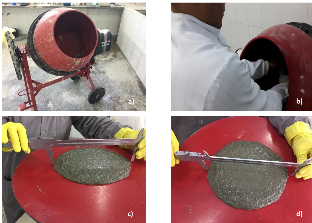
Figura 19 - (a) betoneira utilizada na confecção das argamassas, (b) execução da mistura das argamassas e (c) e (d) ensaio de espalhamento das argamassas.
