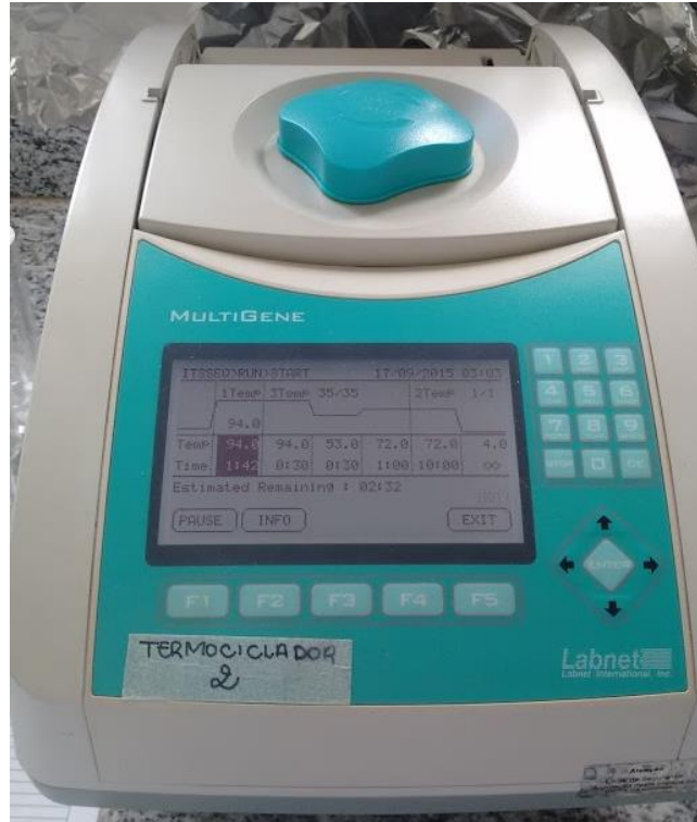
Figura 8 – Termociclador com as programações de temperatura e números de ciclos
