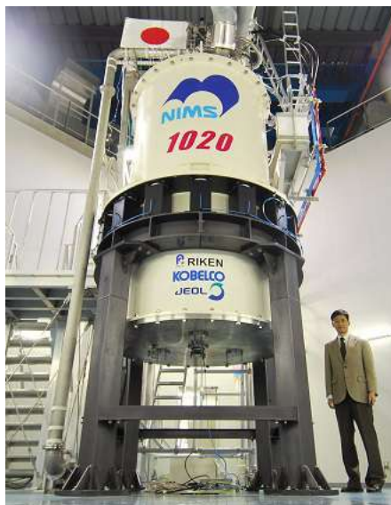
Figura 2.15 - Imagem de um super equipamento de ressonância magnética nuclear
