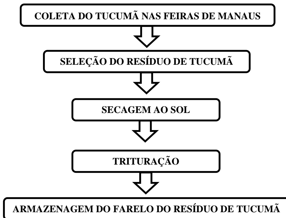
Figura 06: Fluxograma para a obtenção do farelo de tucumã.
