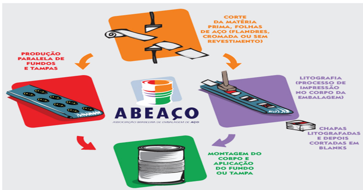
FIGURA 07 - Ilustra o processo de produção da lata.
