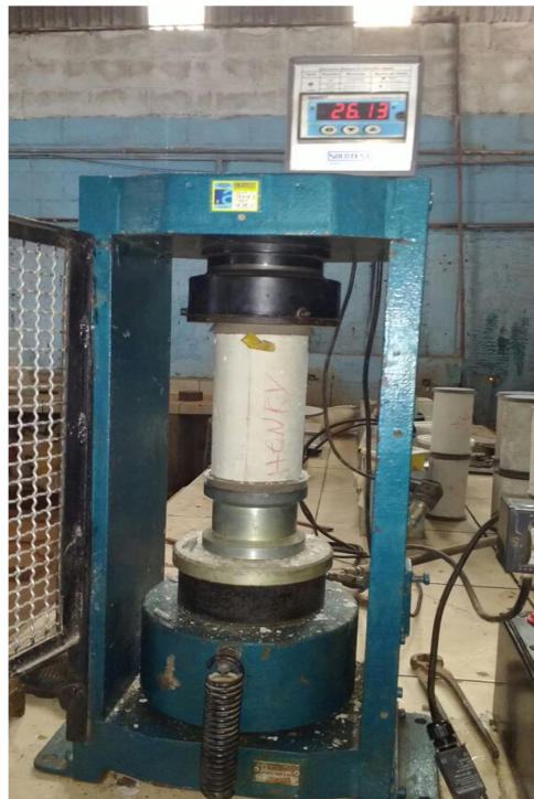
Figura 27 - Corpo de prova na prensa, ensaio de compressão axial.
