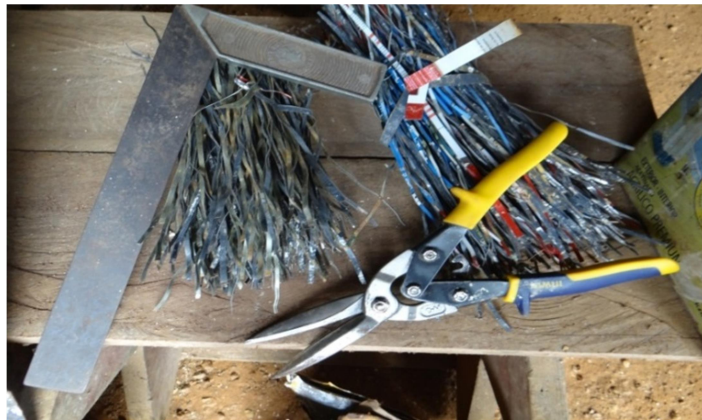
Figura 18 - Pacotes de fibras produzidos, corte padronizado de 2,5cm de comprimento.
