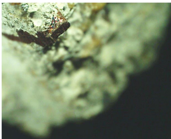
Figura 50 - Interação da fibra (MO) com a matriz concretícia, de 1,5% (F4).
