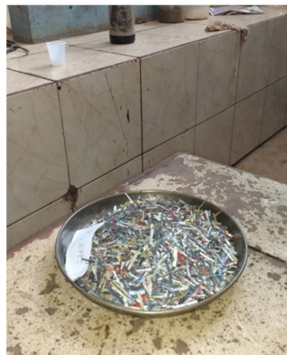
Figura 20 - Fibras de aço selecionadas e pesadas em conformidade com a dosagem estabelecida.
