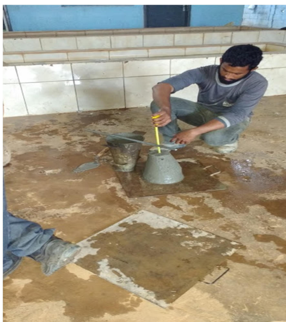
Figura 62: Determinação da consistência pelo abatimento do tronco de cone(NBRNM67) – Fonte: Autor
