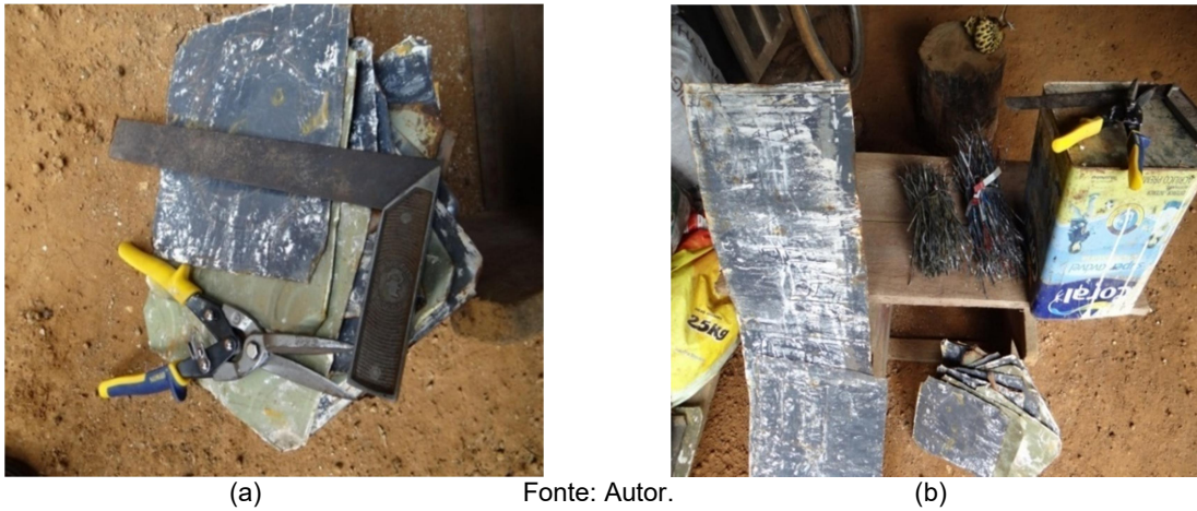
Figura 15 - Lateral (a) e fundos das latas (b) partes aproveitadas para a confecção das fibras.
