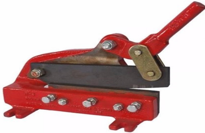
Figura 17 - Tesoura/Guilhotina Corta Chapa Nº4 MOTOMIL- Modelo MTC – 04
