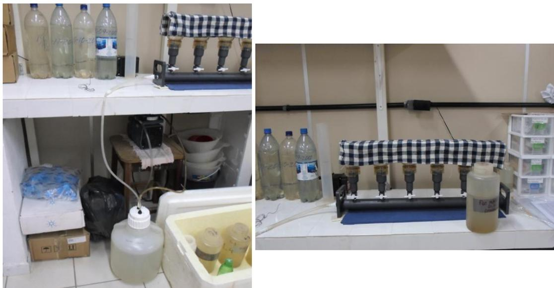
**Figura 18-** Bomba a vácuo e filtros, instrumento utilizado para realizar a medição de MES.
