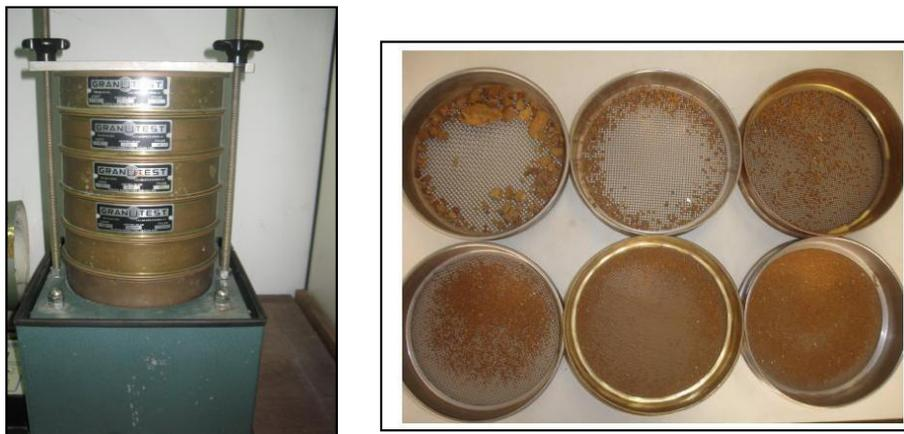
**Figura 17** - Peneirador mecânico que foi utilizado nas separações das frações de areia.
