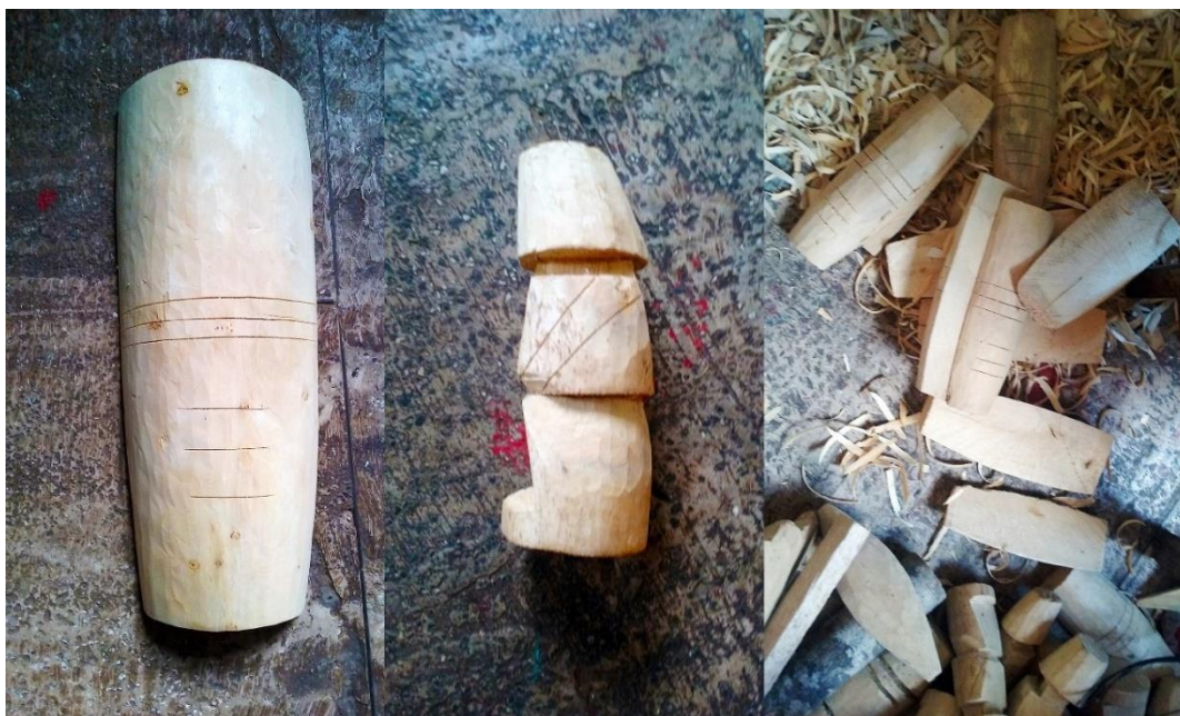
Figura 36 – Marcações feitas sobre a madeira, com a serra manual.
