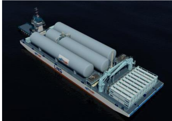
Figura 23 – Balsa de calado raso para abastecimento de GNL
