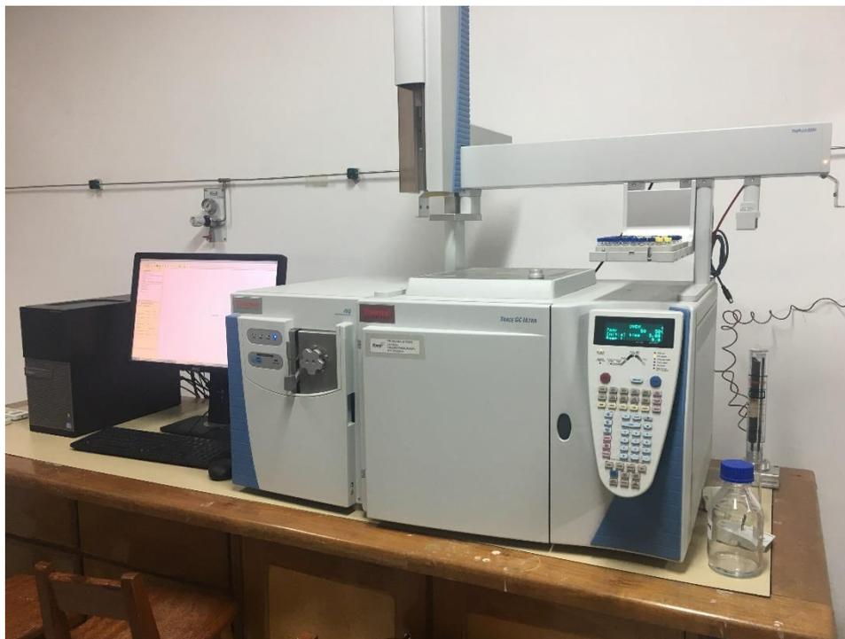
Figura 9. Cromatógrafo Gasoso Acoplado ao Espectrometro de Massas (CG-EM) – Thermo Scientific (Trace GC Ultra e o ISQ Single Quadrupole MS). Central Analítica – Laboratório de Cromatografia Gasosa (Lab-CG) – UFAM.
