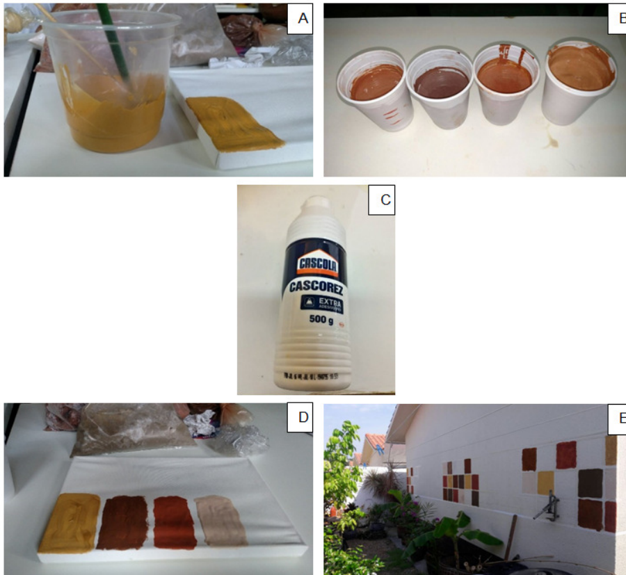
Figura 20: A – Tinta feita a partir do amostra P8-01. B – Algumas outras tintas elaboradas. C – Cola PVA utilizada na formulação das tinta. D – Aplicação delas em um quadro branco. E – Aplicação em uma casa.
