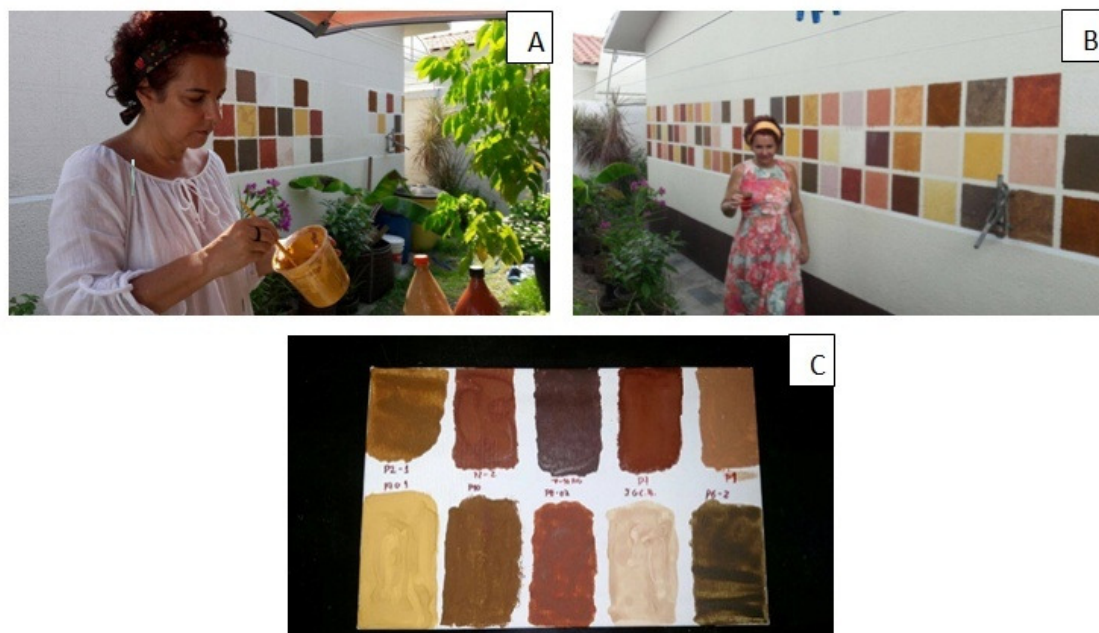
Figura 5: A – Aplicação da tinta. B – Tinta aplicada. C – Comparação das tintas e a coloração obtida a partir dos materiais.
