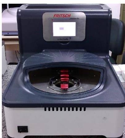
Figura 14 - moinho planetário modelo FRITSCH pulverisette 7.
