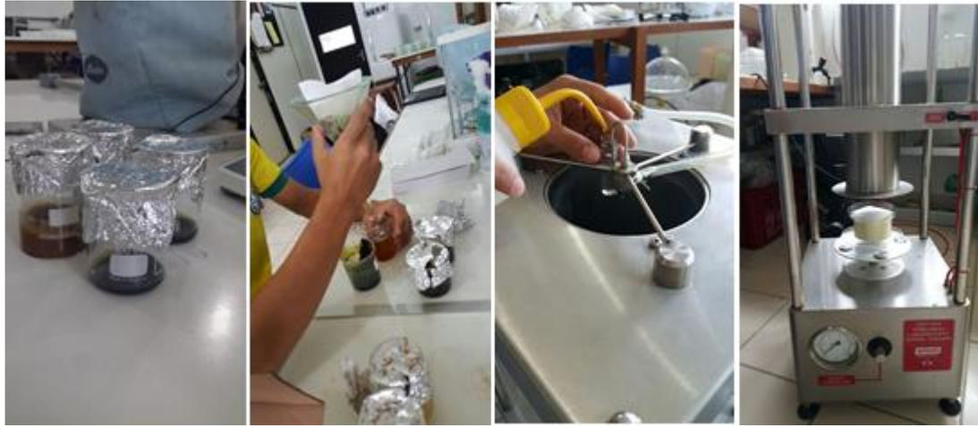
**Figura 3.4.** Preparo e aplicação dos extratos vegetais em papel filtro com auxílio da Torre de Potter em laboratório.
