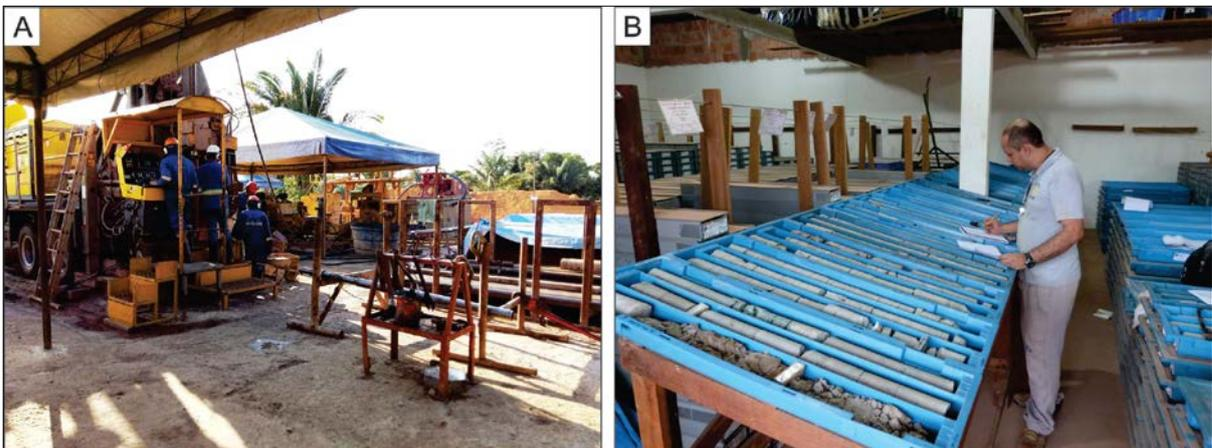
Figura 2: Descrição macroscópica de testemunhos de sondagem. A) Sonda Atlas Copco CS-4002; B) Descrição das caixas de amostras no galpão da empresa (Autazes).
