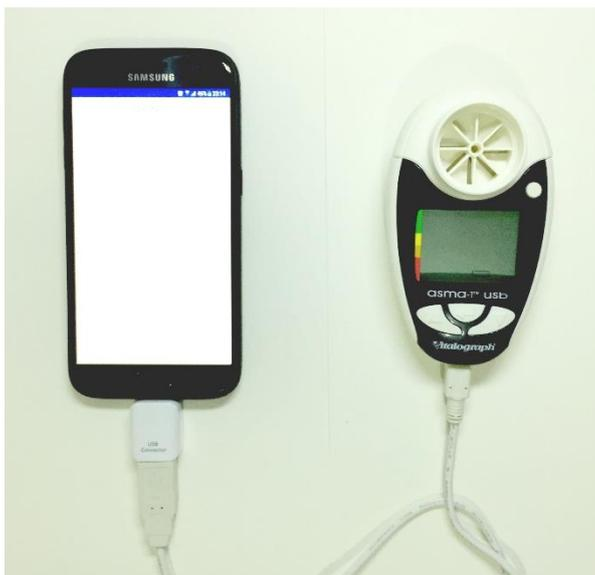
**Figura 29. Conexão do medidor de pico de fluxo respiratório ao dispositivo móvel.**
