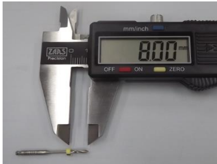
Figura 5: Comprimento da broca largo #6 conferido com paquímetro digital.
