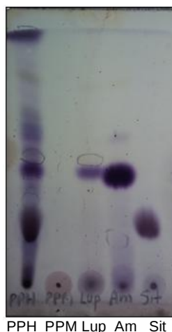
Figura 4. Placa de CCD dos extratos brutos de PPH e PPM com padrões de substâncias conhecidas
