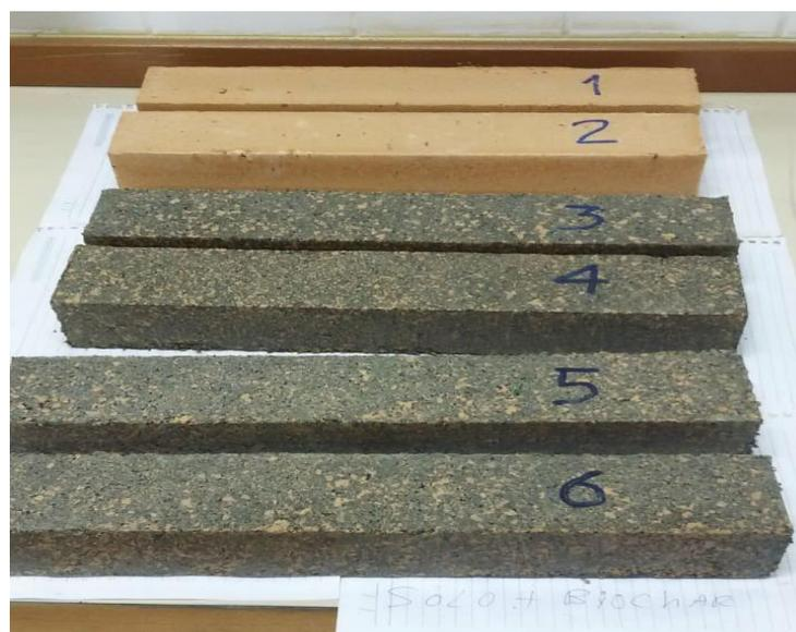
Figura 4.5 – Vigas de solo para ensaio de flexão a 4 pontos
