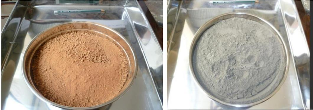
Figura 2.13 – Argila vermelha e cinzas volantes de carvão usados em estabilização de bases
