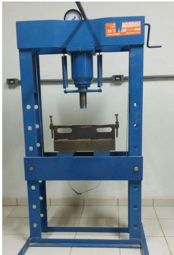
Figura 3.10 – Prensa para moldagem de corpo de prova prismático
