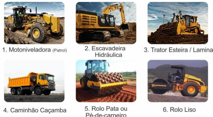
Figura 2.1 – Principais equipamentos usados em terraplenagem
