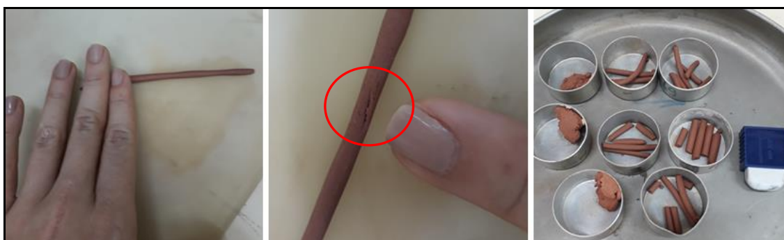
Figura 25: A) rolagem da massa de solo em uma placa de vidro para determinação do LP; B) fissura na amostra de solo (destacado em vermelho); C) cápsulas com cilindros das amostras analisadas
