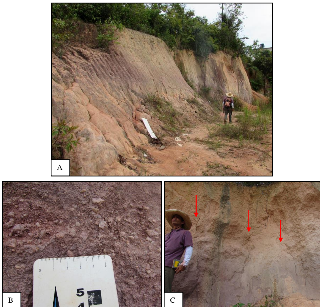
Figura 36: A) visão geral do afloramento B) fragmentos de rocha; C) fraturas verticais no talude (destacadas pelas setas vermelhas)
