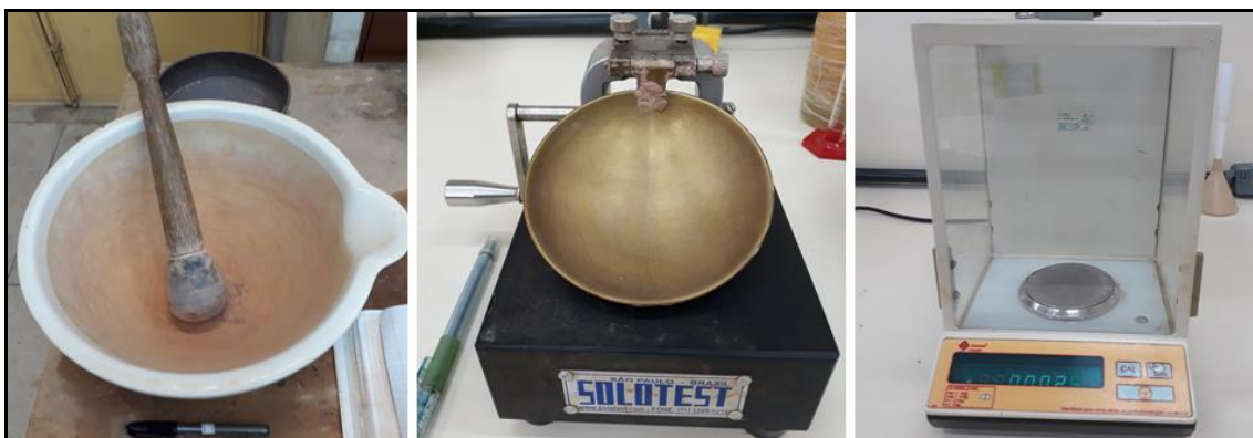
Figura 18: Materiais utilizados nas análises de liquidez, plasticidade e granulometria das amostras de solo, (continua)
