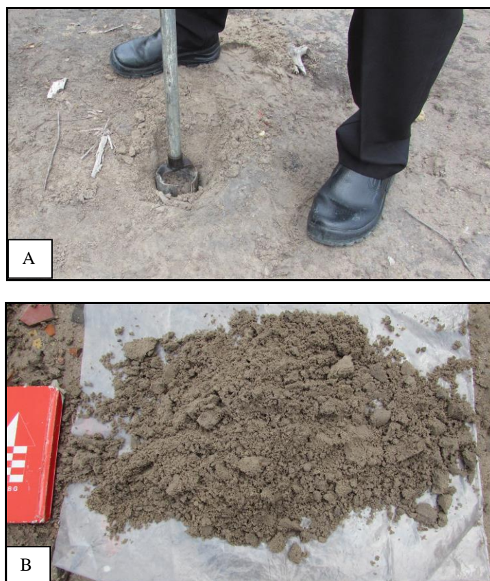
Figura 39: A) sondagem a trado; B) amostra coletada
