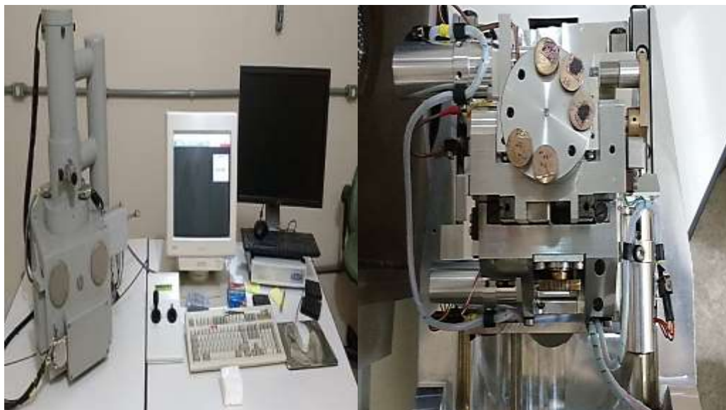
Figura 17: Microscópio eletrônico de varredura Carl Zeiss, modelo LEO435VP.
