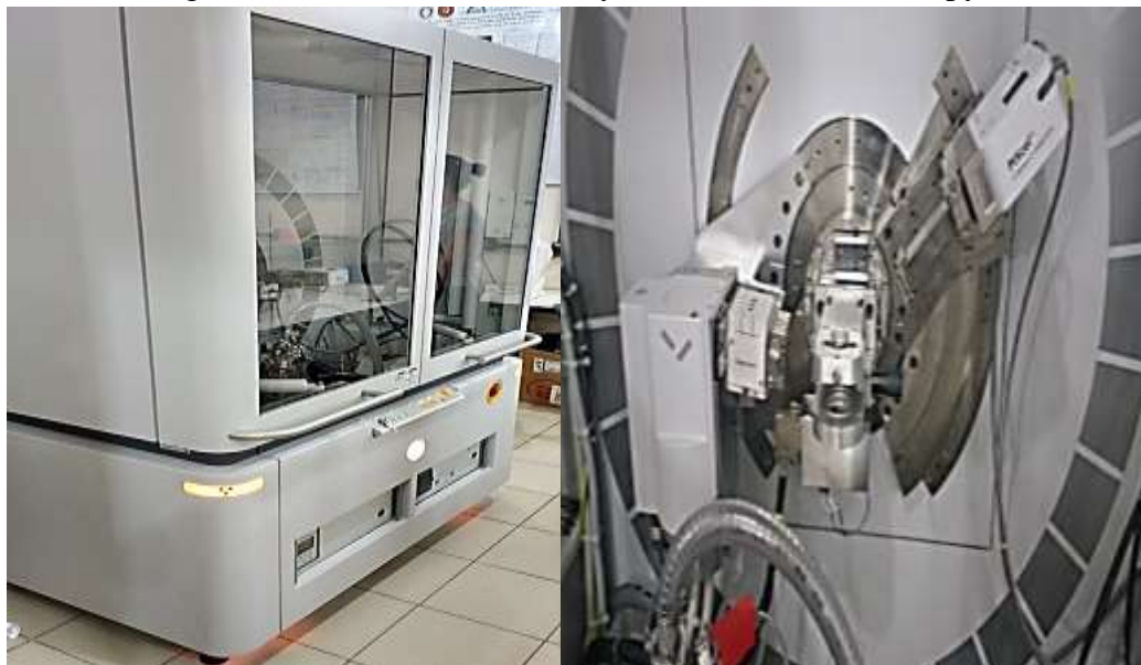
Figura 16: Difratômetro PANalytical, modelo DRX-Empyrean.
