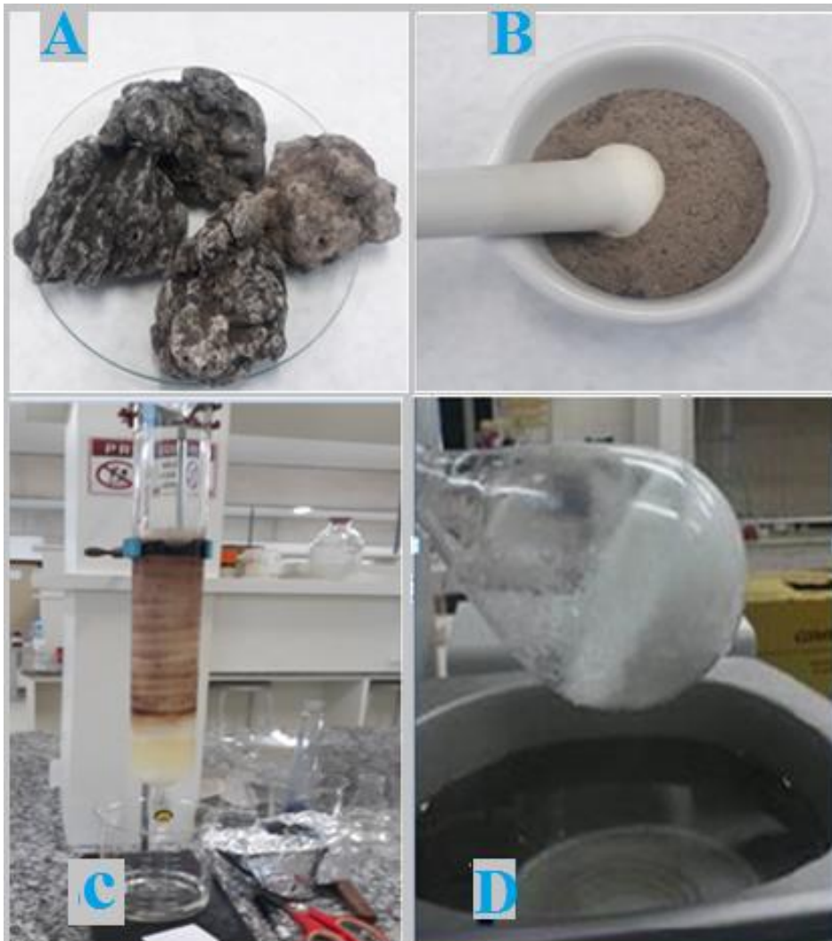
Figura 6 - Processo para obtenção e isolamento da mistura isomérica \alpha,\beta -amirina a partir da resina do Protium sp. A) amostra de Protium sp. comercial; B) processo de trituração; C) coluna cromatográfica utilizando a amostra diretamente na coluna e D) processo de rota-evaporação das frações com presença de \alpha, \beta -amirina
